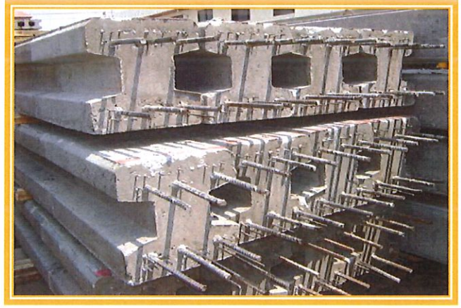
เสาเข็มรูปตัวไอมี DOWEL BAR ออกมาด้านนอก
